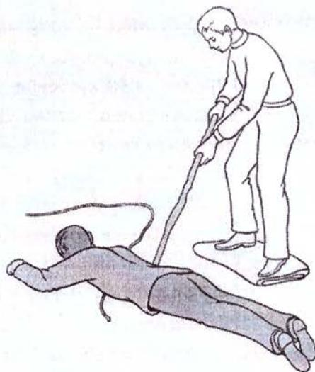
Рис. 1 Отодвигание пострадавшего от источника электрического тока с помощью сухой палки.
